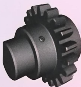
回转零件和轴的连接
